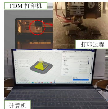
图3 FDM 3D打印示意图
